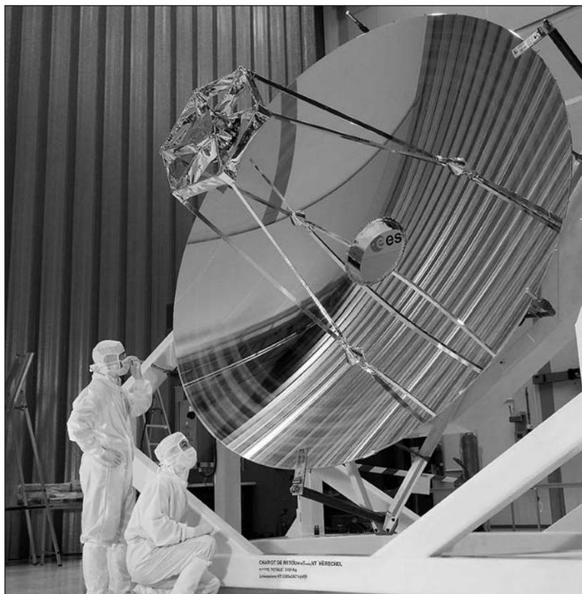
*Зеркало космического телескопа «Herschel» диаметром 3,5 м изготовлено из карбида кремния — легкого керамического материала, устойчивого к нагрузкам и экстремальным температурам. Зеркальная поверхность имеет отклонения от идеальной не более 1 мкм.*
